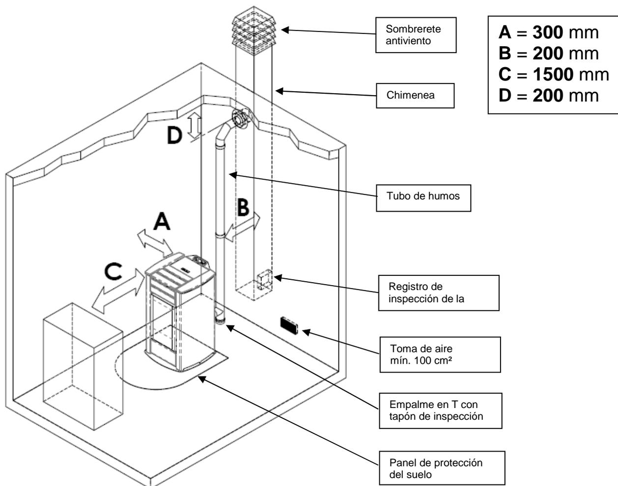
Alrededor de la estufa debe quedar espacio suficiente y de fácil acceso para hacer el mantenimiento periódico. La estufa tiene cuatro pies regulables para compensar los posibles desniveles del suelo. Para nivelarla, inclínala ligeramente y gire el pie que necesite regulación.
