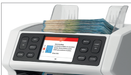
Muestra un mensaje detallado cuando se detecta un billete sospechoso
