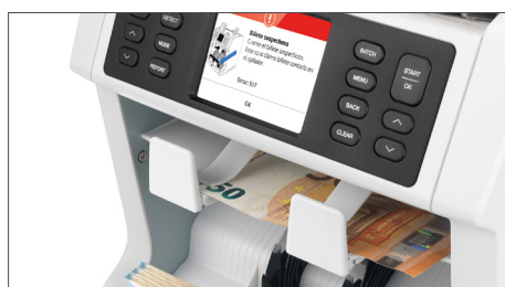
Coloca los billetes falsos sospechosos en una bandeja de rechazos dedicada
