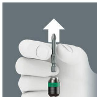
Para cambiar la punta simplemente se ha de desplazar el casquillo hacia adelante: En ese instante, el mecanismo de muelle separa la punta del imán y desbloquea así la herramienta. La punta se puede extraer sin problema alguno. Y lo que es especialmente útil: esta función también permite la extracción de puntas de dimensiones muy pequeñas sin que se tenga que utilizar herramienta adicional de ayuda.
